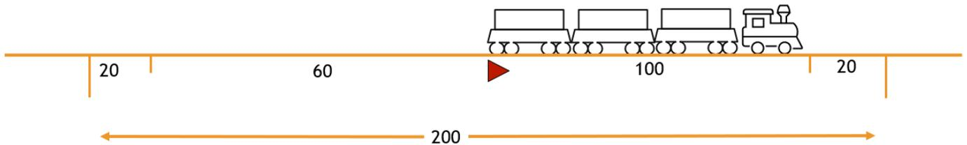
Es wird angenommen, dass die Länge des einfahrenden Zuges 100cm beträgt. In diesem Fall geht die Software davon aus, dass der Zug im rechten Teil des Blocks zum Stehen gekommen ist und 60cm (160cm minus 100cm) im linken Teil des Blocks zum Abstellen weiterer Fahrzeuge bleiben.
